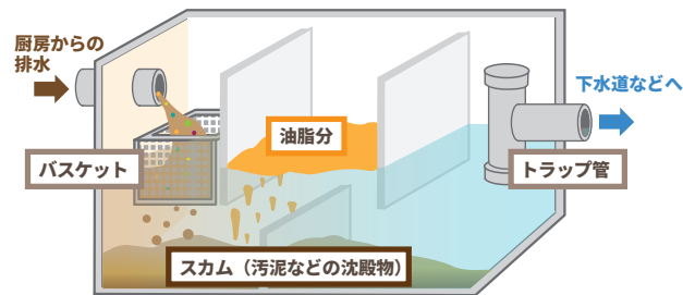
グリーストラップ断面図イメージ
